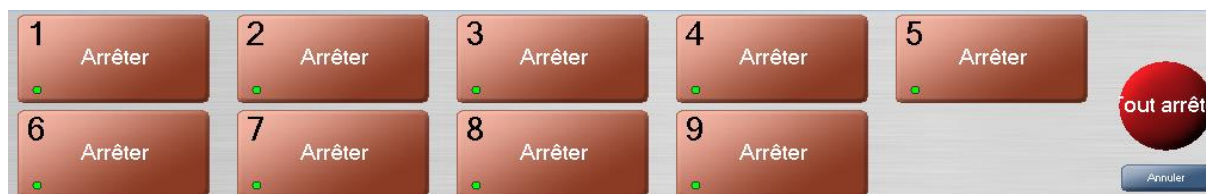
Les touches d'arrêt de pompes
